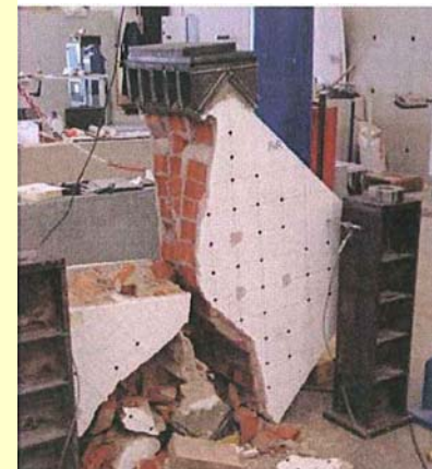
Quadro fessurativo della muratura non rinforzata : il muretto "scoppia"
